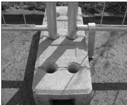
Betonfuß mit Aushebesicherung Art.-Nr. 29341 (hakenseitig am Zaun einzuhängen, dadurch Sicherung von 2 Zäunen).
