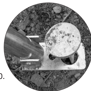
Besonders in schwierigem Gelände läßt sich die Bauzaunabstützung flexibel einsetzen. Die Bauzaunabstützung wird mit dem Befestigungssatz verschraubt. Die Höhenverstellung erfolgt durch Verschieben des Befestigungssatzes (nur Art.-Nr. 29340).
