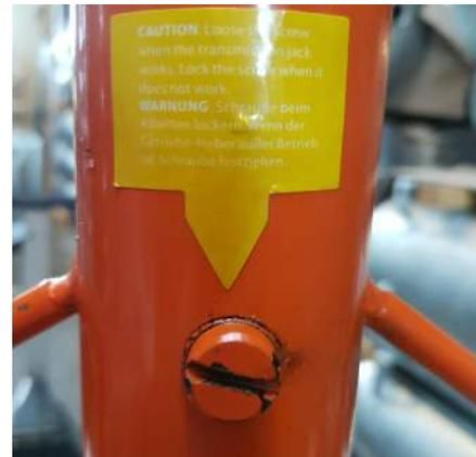
Abb. 4: Entlüftungsschraube
